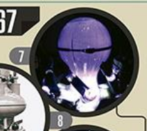
7 Antes de la electrónica de potencia: Antes de que los diodos, tiristores y los IGBT's estuvieran disponibles, las corrientes eran rectificadas con rectificadores de selenio, o con rectificadores de arco de mercurio gigantes emitiendo luz azul misterioso.
